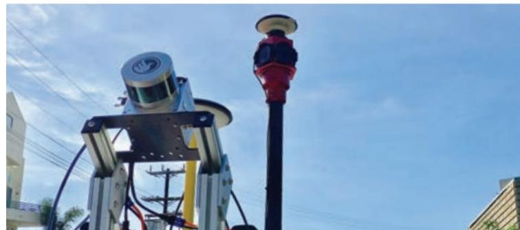
По-настоящему простая в установке система Scout-16 может быть оснащена системой крепления на автомобиль, которая позволяет одновременно вести фотосъемку 360°
